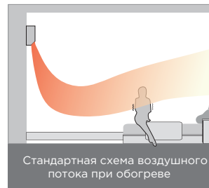
Схема воздушного потока при обогреве с эффектом Коанда
