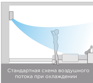
Схема воздушного потока при охлаждении с эффектом Коанда
