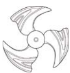
Лопasti с высоким статическим давлением
