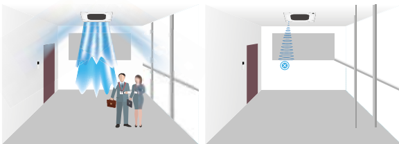
Внутренний блок автоматически включается при обнаружении человека
