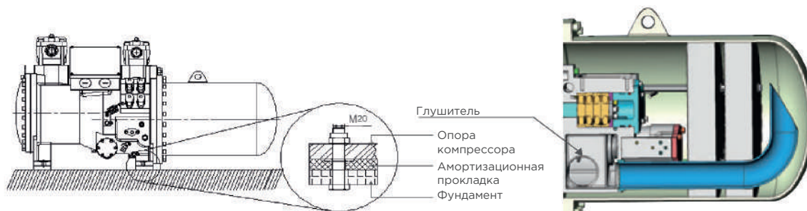
Схема монтажа амортизационной прокладки
