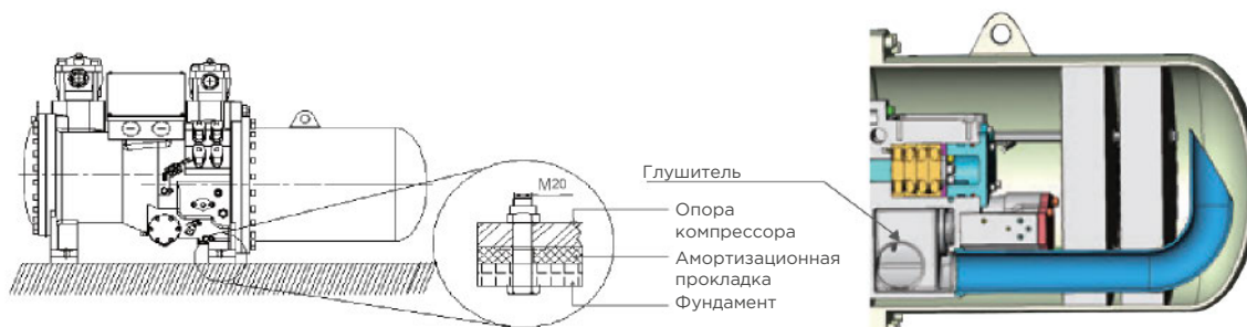
Схема монтажа амортизационной прокладки
