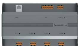
Предназначен для интеграции систем DX PRO в систему управления зданием (BMS), использующую протокол BACnet.
