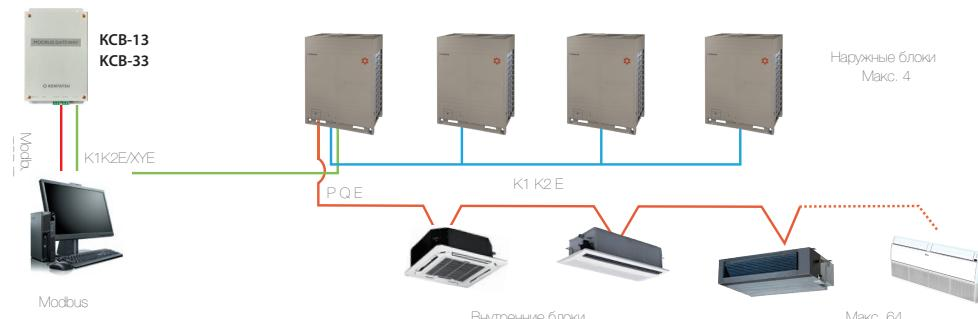
Передача данных по протоколу RTU
