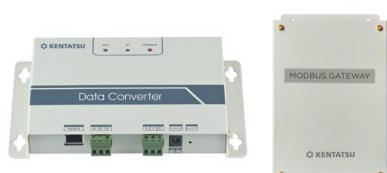
Шлюз Modbus предназначен для интеграции центральных многозональных систем кондиционирования DX PRO в систему управления зданием (BMS) по протоколу Modbus RTU или TCP. К одному шлюзу KCB-13 можно подключить одну систему кондиционирования DX PRO (в системе может быть объединено до 4 наружных модулей и до 64 внутренних блоков). В одну Modbus-сеть можно объединить до 16 устройств KCB-13 или KCB-33 с возможностью управления 1024 внутренними блоками и 64 наружными.
