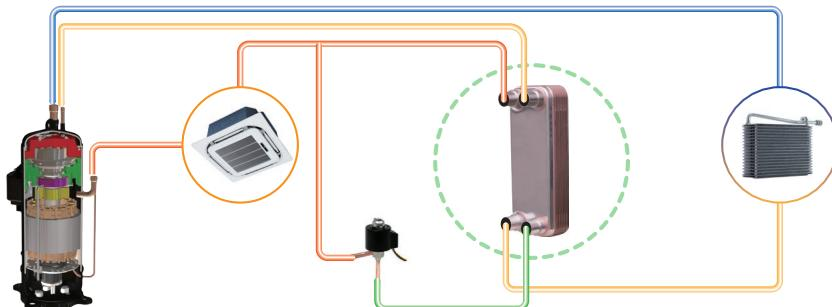
Вторая стадия переохлаждения: используется экономайзер (дополнительный пластиначатый теплообменник).
