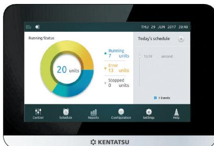
Самый современный центральный пульт управления для DX PRO\* систем оснащен сенсорным дисплеем с диагональю 6,2 дюйма. Пульт поддерживает одновременное управление 8 системами DX PRO и 64 внутренними блоками. С помощью него можно не только задать основные параметры работы блока, такие как установка температуры или скорости вращения вентилятора, но и составить расписание работы блока.
