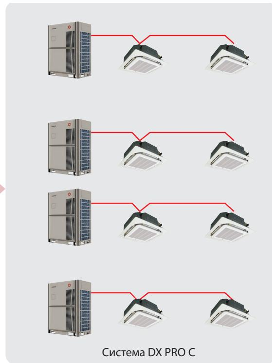
KCB-NET - модуль управления системами кондиционирования DX PRO C и DX PRO CH с помощью компьютера. Обеспечивает централизованное управление и мониторинг до 1024 внутренних блоков. Конфигурация системы KCB-NET зависит от количества систем и их расположения на объекте. В группе с KCB-NET обязателен к установке шлюз KCB-GW.
