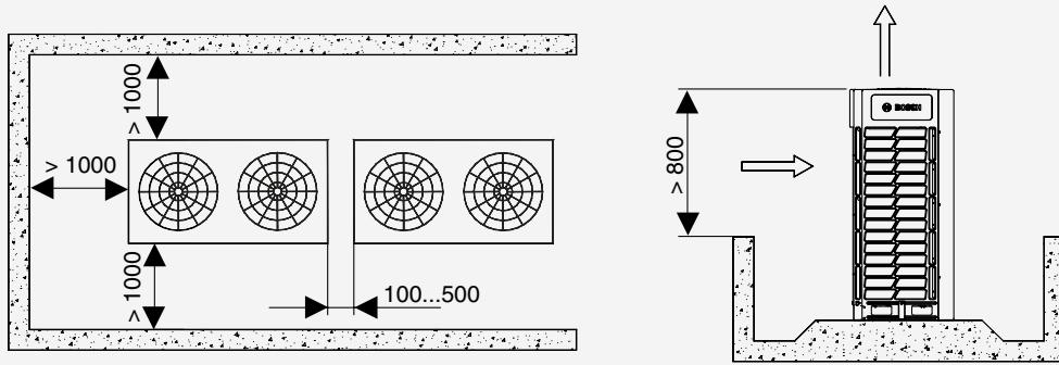
Установочные размеры (в мм) блоков серии Air Flux 6300 A (C) – несколько блоков друг напротив друга
