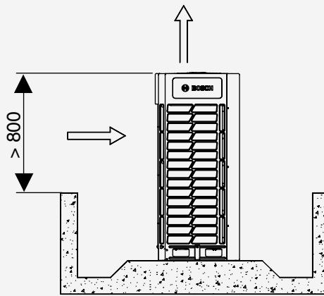
Установочные размеры (в мм) блоков серии Air Flux 5300 A (C) – несколько блоков друг напротив друга
