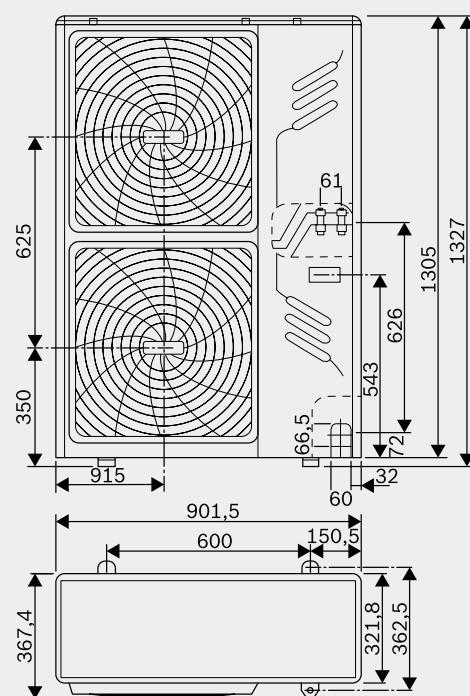
Размеры (в мм) блоков серии MDCI мощностью 20–26 кВт
