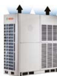
Функция автоматического удаления снега защищает наружный блок от снега. Вентиляторы автоматически включаются на короткий промежуток времени и удаляют снег. Эта функция включается с помощью микропереключателя на печатной плате наружного блока.
