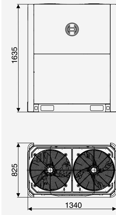
Размеры (в мм) блоков серии Air Flux 5300A (C) мощностью 67–90 кВт
