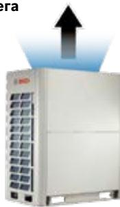
Функция автоматического удаления снега защищает наружный блок от снега. Вентиляторы автоматически включаются на короткий промежуток времени и удаляют снег. Эта функция включается с помощью микропереключателя на печатной плате наружного блока.
