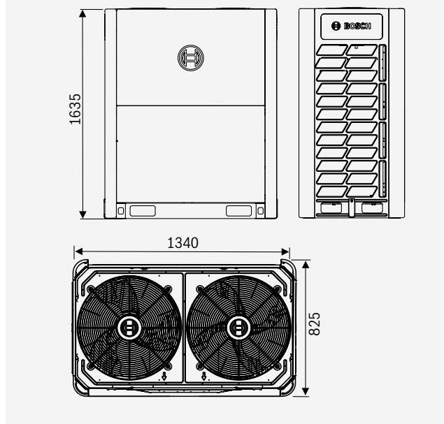
Установочные размеры (в мм) блоков серии Air Flux 6300A (C) – несколько блоков рядом друг с другом
