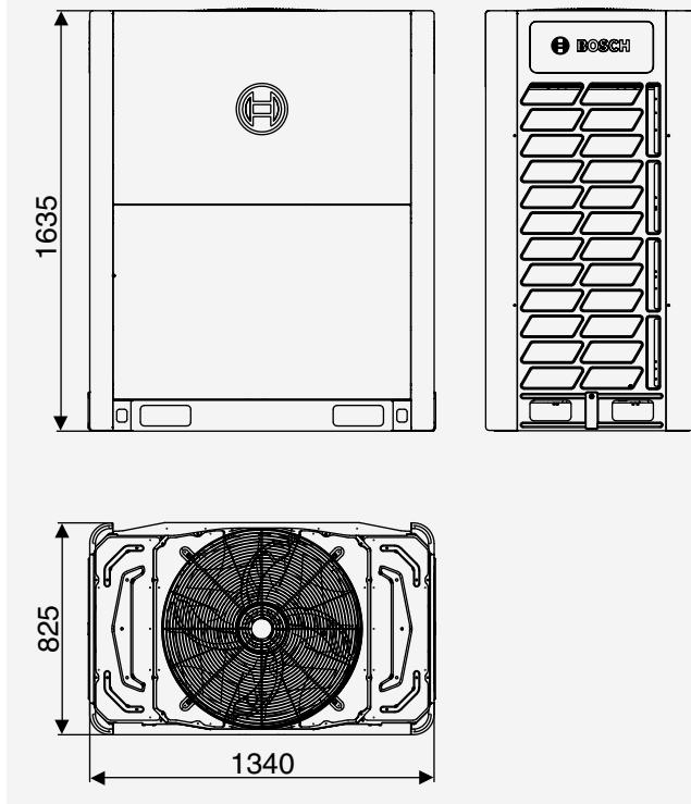
Размеры (в мм) блоков серии Air Flux 5300A (C) мощностью 50–60 кВт
