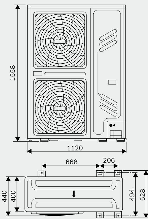
Размеры (в мм) блоков серии MDCI мощностью 40–45 кВт
