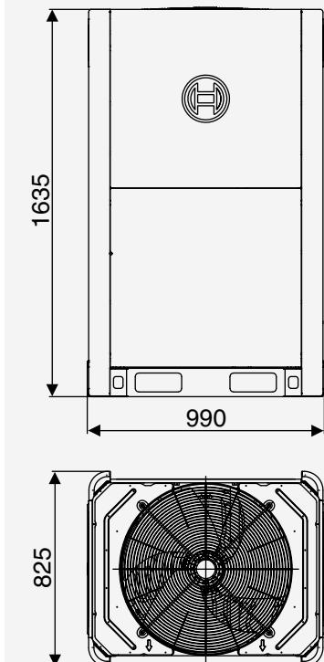
Размеры (в мм) блоков серии Air Flux 5300A (C) мощностью 45–50 кВт
