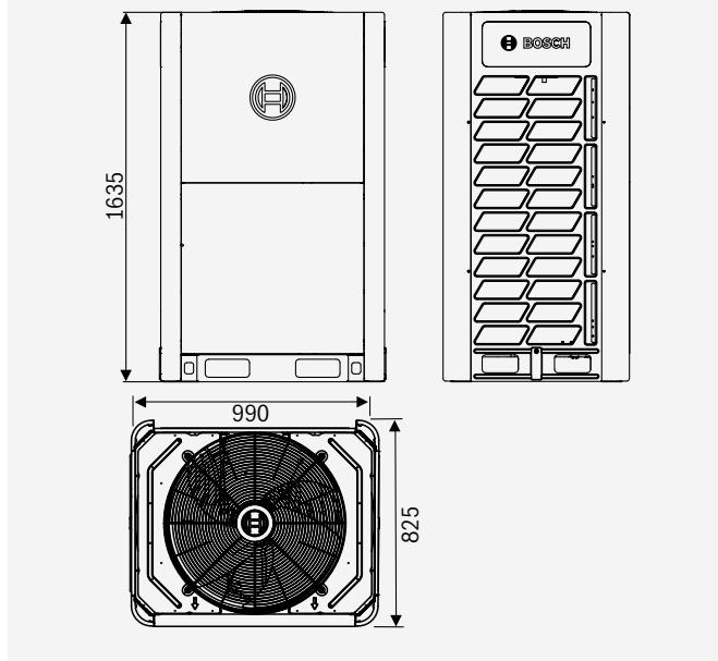
Размеры (в мм) блоков серии Air Flux 6300A (C) мощностью 40–50 кВт
