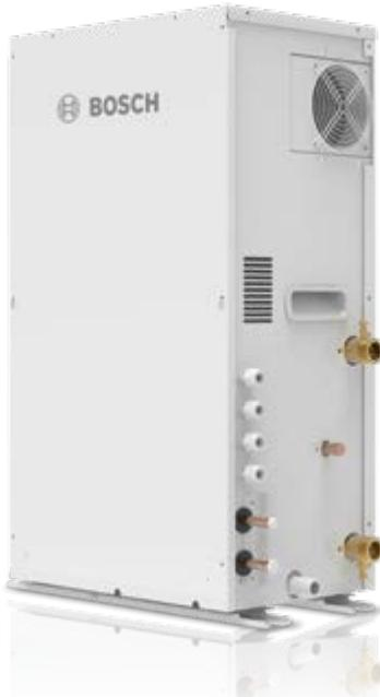
Hydro Box AF-HB 140-1 представляет собой гидравлический соединительный модуль подготовки горячей воды для бытовых нужд, работающий с блоками серии AF6300A. Гидромодуль Hydro Box имеет свой холодильный контур (с хладагентом R-134a), включая компрессор. В систему с гидромодулем Hydro Box также должны входить внутренние блоки VRF (с производительностью не менее 50% от производительности наружного блока).
