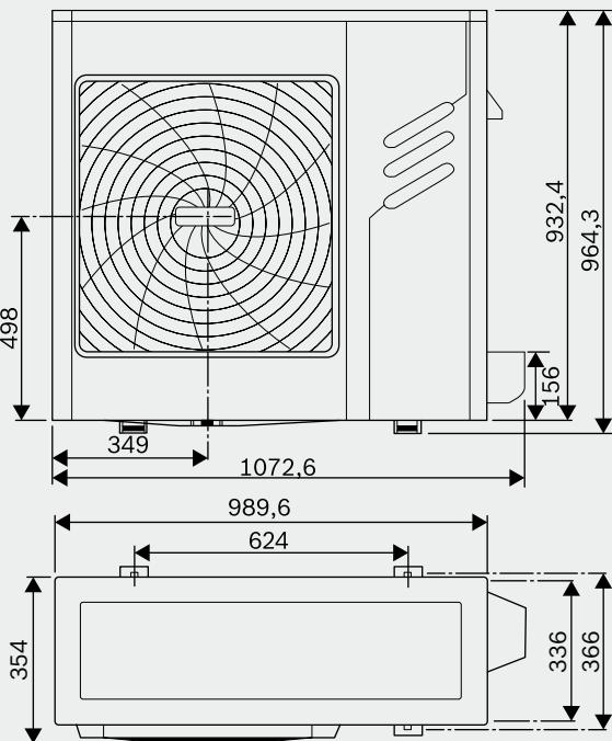
Размеры (в мм) блоков серии MDCI мощностью 12–18 кВт
