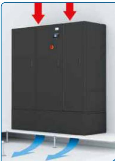
Исполнение для установки внутри ЦОД по периметру с высотой фальшпола менее 550 мм. В этом случае поставляется цоколь-основание с фиксированной высотой 550 мм и боковыми панелями, устанавливаемый над полом. Необходимо убедиться, что высота потолка достаточная для обеспечения требуемого забора воздуха.
