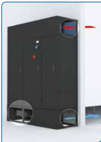
Исполнение для установки снаружи ЦОД, без фальшпола, с тыльным забором воздуха. В этом случае поставляется цоколь-основание с фиксированной высотой 550 мм, боковыми панелями и воздухозаборными решетками с тыльной стороны. Опционально (в случае отсутствия воздуховода) возможен монтаж короба с системой тыльного повторного забора воздуха.
